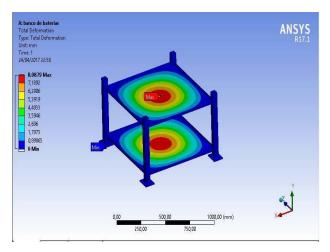
Fig. 3. Load Analysis using FEM
